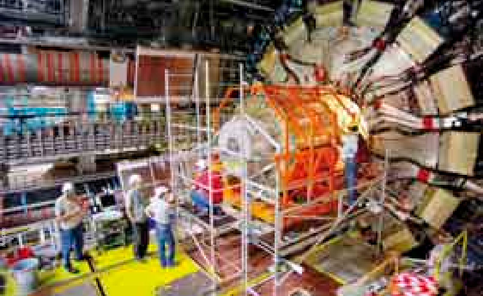
Dette er ikke et rumskib fra Star Wars, det er ATLAS-detektoren midt på LHC-røret, der er i stand til at registrere en ufattelig mængde data, når 40 millioner protoner kolliderer hvert sekund.
